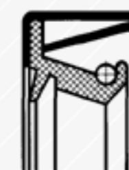
WCR se sevřenou elastomerovou manžetou a ochranným břitem
